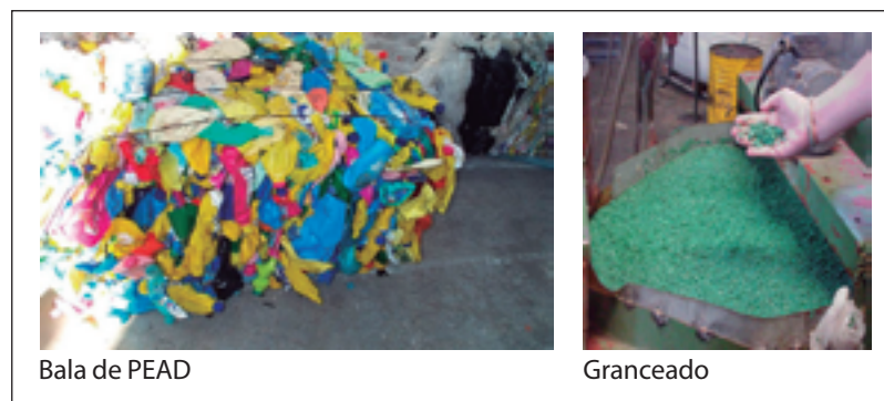
Fotografías del proceso de reciclado de PEAD / Fuente: Ecoembes, S.A.
