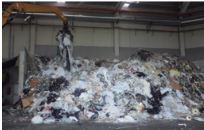
Fracción rechazo en playa de descarga para fabricación de CSR / Fuente: Cátedra Ecoembes
