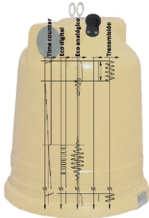
Funcionamiento de un detector de llenado en contenedor / Fuente: Ecoembes
