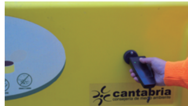
“Transponder” identificador del contenedor / Foto: F. Blázquez
